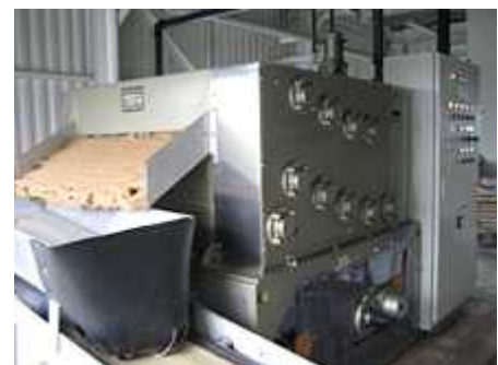
汚泥脱水機（森永デザート）
